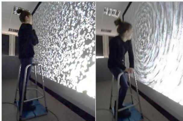
Figure 1 : La plateforme PIVVIT, dispositif de vision panoramique en champ large basé sur la RV, utilisant les flux optiques pour stimuler l'interaction vision-équilibre dans les protocoles thérapeutiques.
